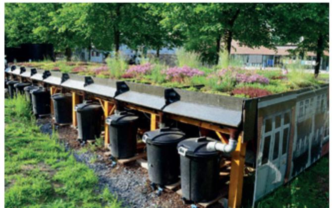
Abb. 1: Gründach-Versuchsanlagen mit Messeinrichtungen in Münster (10 Flächen á 3 m<sup>2</sup>). Foto: Isabel Scherer, FH Münster
