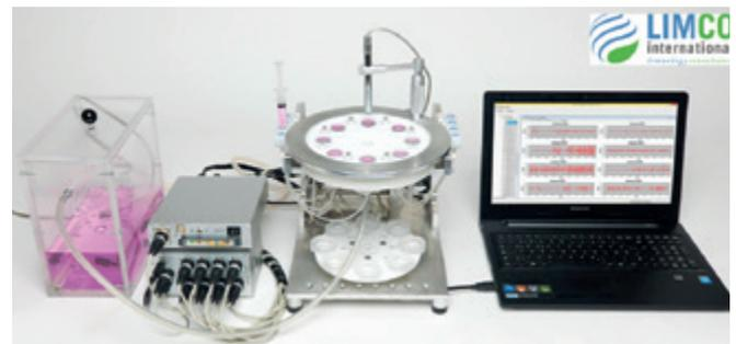
Abb 3: Der Aufbau des Ökotox Biomonitor der Firma LimCo International GmbH. Foto: LimCo International GmbH
