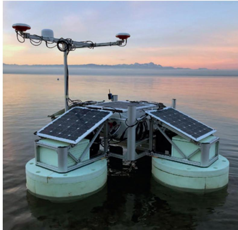
Abb. 2: Universell einsetzbares, autonom operierendes Messsystem Hydrocrawler. Messfahrt des Hydrocrawlers zur hochauflösenden, flächendeckenden Vermessung der Seebodentopographie und Sedimentstratigraphie auf dem Bodensee.
